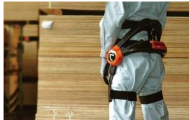
▲モーターで動くアームが太ももを押し、腰への 負担約4割軽減「ロボットスーツ HAL」 (大和ハウス工業株式会社)
