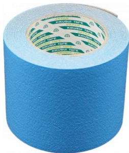
U字溝の継ぎ目を簡易補修するための製品。 目地の隙間がある箇所はテープを詰めて炙る ことで補修ができる
