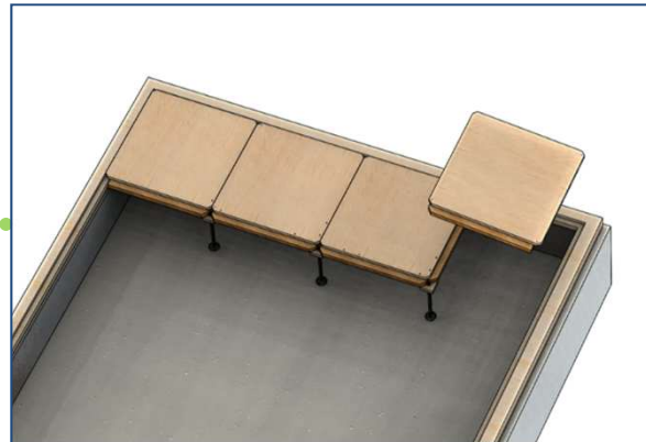
⑤ 1列目最後のパネルの施工
