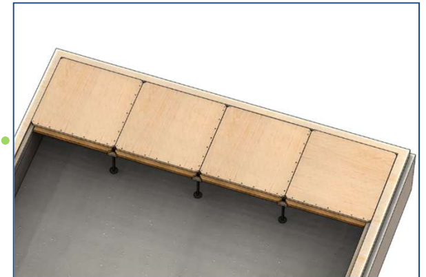
⑥ 1列目の施工が完了
