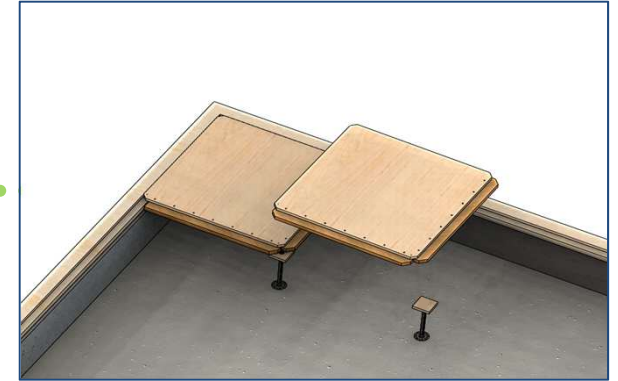
③ 2枚目連結パネルの施工
