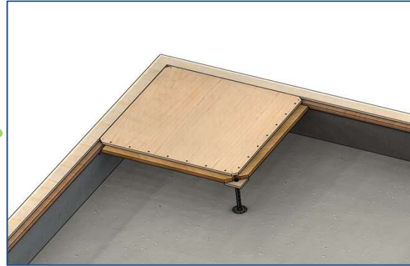
② 1枚目スタートパネルの施工
