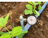
圃場での乾燥試験 (pFメーターにより灌水量を調整)
