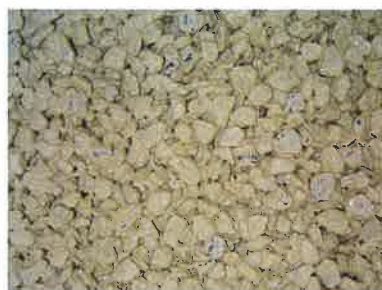
Kーグランド (C) 透水性・保水性舗装表面
