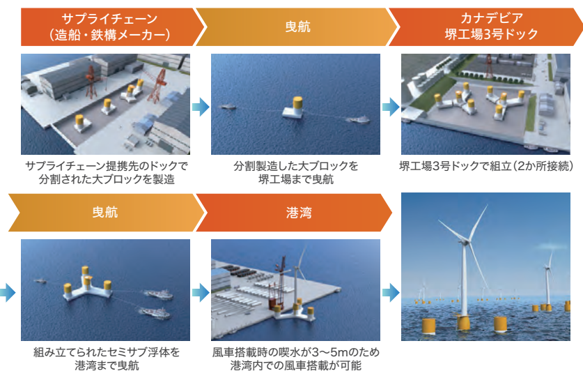
セミサブ型浮体基礎(浮体式) 銅製の箱形状のブロックで構成された海に浮かせる型式の基礎。波による揺れを抑えるため、浮体を所定の喫水まで沈めて半潜水状態としている。 詳細はこちらをcheck
