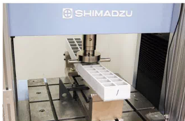
FRGカバー曲げ載荷試験状況(正曲げ)
