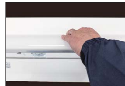
コネクタと脱落防止用ヒモを 挟まないようにLEDバーを本体 に押し上げます。
