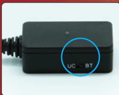
USB(COM)/Bluetooth(SPP) の切替スイッチ搭載
