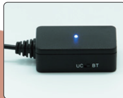
Bluetooth (SPP) モード時【青色 LED 点滅・点灯】
